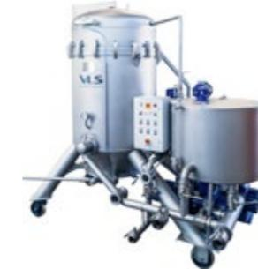
**Filtro a farina con settori verticali e scarico automatico per olio**
