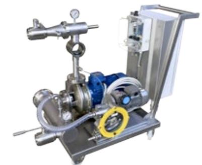
**Pressurizzatori per flottazione a ciclo discontinuo**
